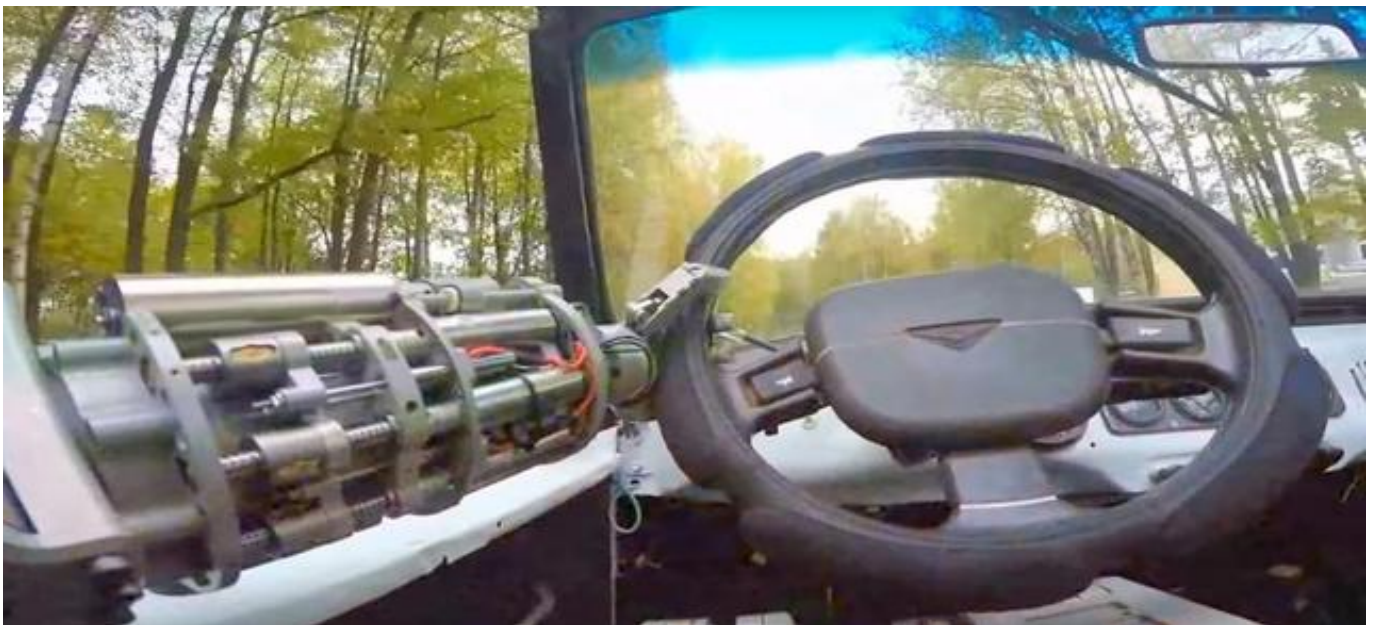
驾驶车辆的机器人手握方向盘。 (来自: 腾讯军事)
